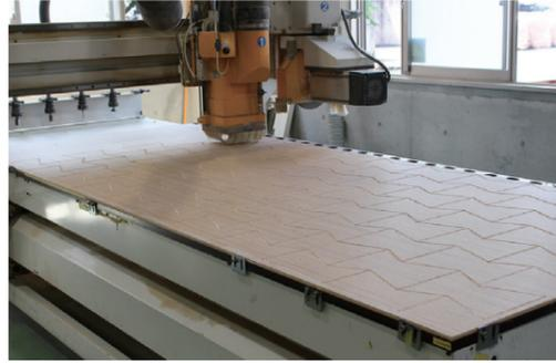
NC加工機によって様々な形状のパネルを製作することが可能です。多角形パネルや曲線を用いたパネルなどで、四角い形状に捕らわれない自由なデザインに対応することが可能です。
